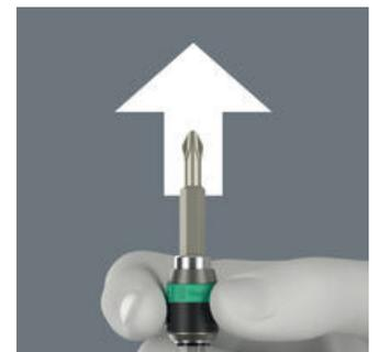
Zum Bitwechsel einfach die Hülse nach vorne schieben: Dabei hebt der Federmechanismus den Bit vom Magneten ab und entriegelt das Werkzeug. Der Bit kann problemlos entnommen werden. Besonders hilfreich: Mühelose Entnahme auch kleinster Bitgrößen ohne Hilfswerkzeug.
