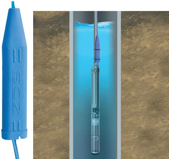
Bei dem **DRP** handelt es sich um ein elektronisches Gerät, welches bei der Unterwassermotorpumpe für einen optimalen Schutz gegen Trockenlauf garantiert. Der **DRP** ist im Motorkabel integriert und sofort einsatzbereit. Sollte sich zu wenig Wasser im Brunnen befinden (wenn der Wasserspiegel unterhalb des Sensors vom **DRP** fällt), unterbricht der **DRP** sofort die Stromzufuhr zur Unterwassermotorpumpe.
