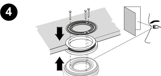
**INSTALLARE LA GUARNIZIONE E AVVITARE LA GHIERA METALLICA**
