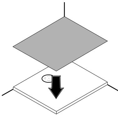
**UPOZORNĚNÍ:** PŘI INSTALACI SAMOTNÉHO VÝROBKU A PŘI OBKLÁDÁNÍ A/NEBO MONTÁŽI KOUPELNOVÉHO PRÍSLUŠENSTVÍ (SPRCHOVÝ KOUT, BATERIE ATD.) VŽDY CHRÁNTĚ POVRCH VANÍČKY POMOCÍ LEPENKY NEBO POLYSTYRENU.
