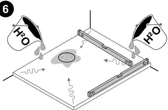
KONTROLLERA ATT PLATTAN DRÄNERAS KORREKT OCH ATT DEN STÅR PLANT
