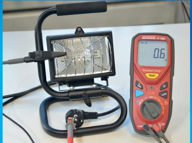
Widerstandsmessung zur Prüfung des Schutzleiters
