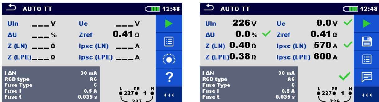
Abbildung 7.74: Beispiele für Ergebnisse der AUTO TT-Messung
