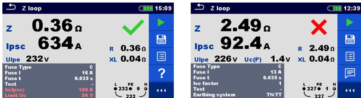
Abbildung 7.32: Beispiele für Ergebnisse der Schleifenimpedanzmessung
