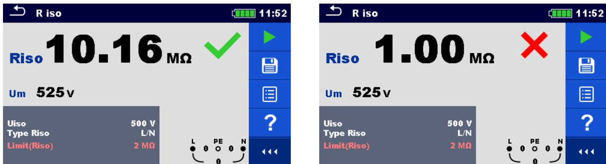
Abbildung 7.8: Beispiele für Ergebnisse der Isolationswiderstandsmessung
