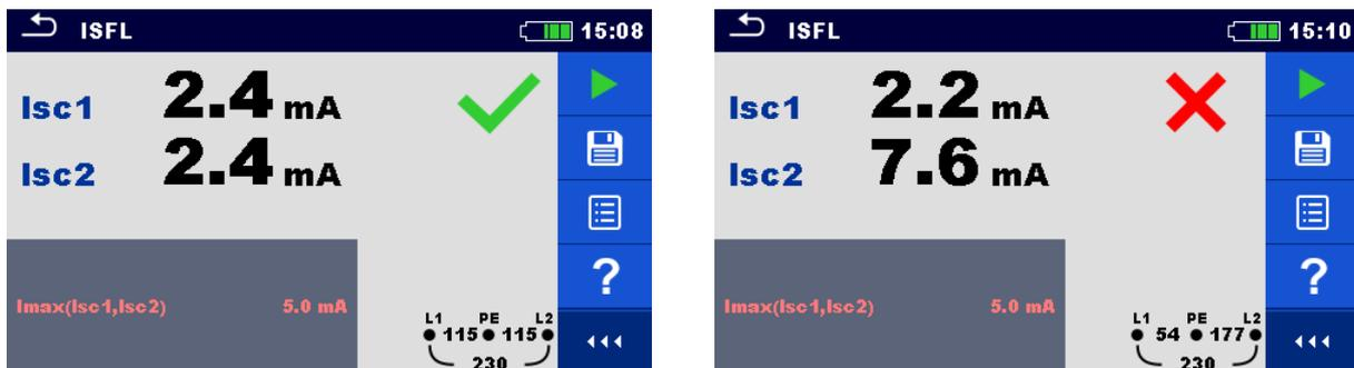
Abbildung 7.65: Beispiele für Ergebnisse des Erstfehler-Ableitstroms
