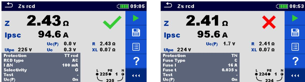
**Abbildung 7.35: Beispiele für Ergebnisse der Zs RCD Messung**
