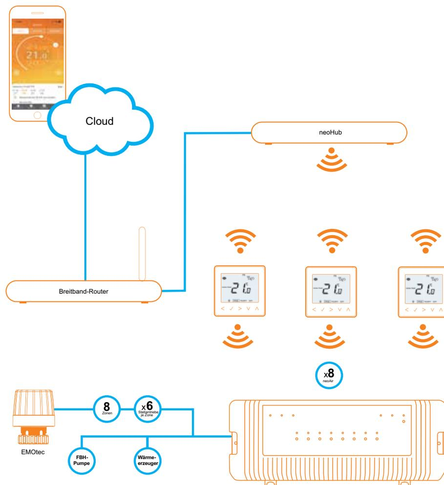
**HINWEIS:** Die Gesamtlast von 5A je Klemmleiste darf nicht überschritten werden, daher beträgt die maximale Anzahl von EMOtec, die mit der Schaltleiste verbunden werden können, 12.
