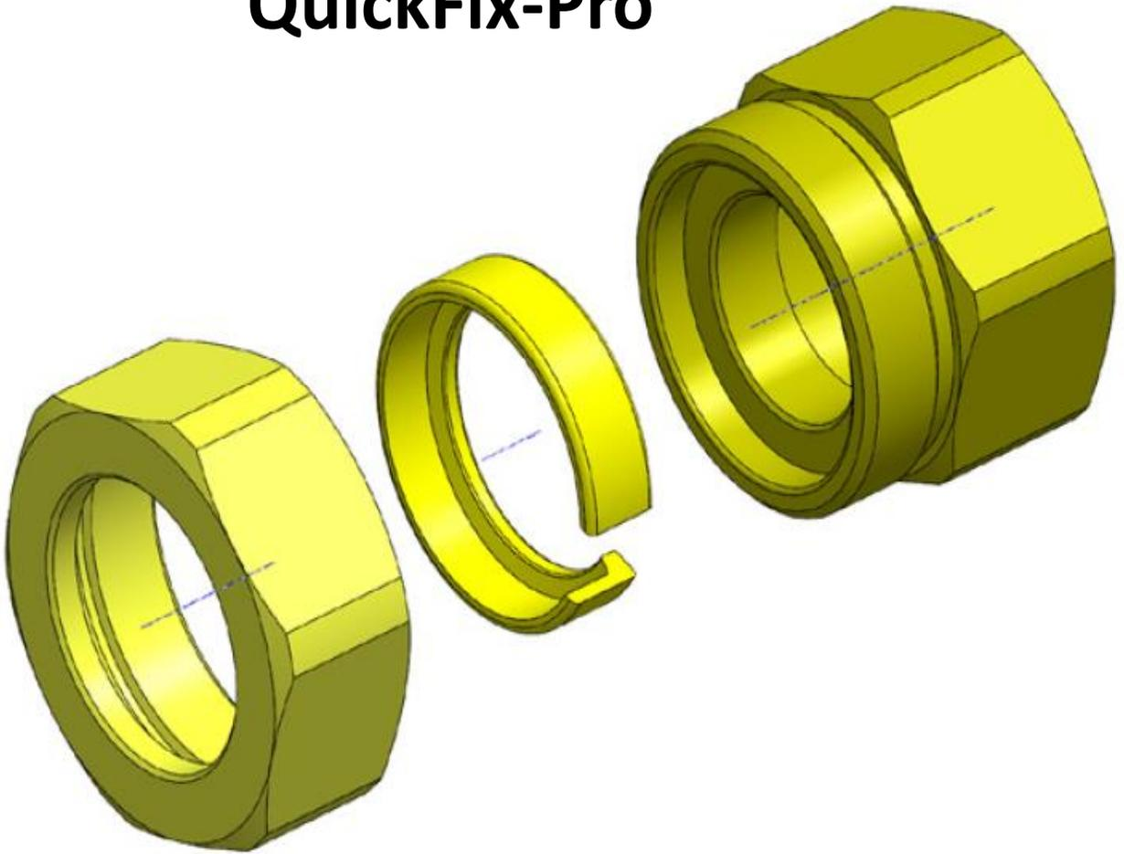
1. Legen Sie die den Halb Ring in die Mutter, wie es in der Abbildung zu sehen ist mit Nut in Richtung Grundkörper.
