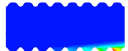
Das Ergebnis ist, dass nach 3,8s eine Länge von 100cm vollständig durchgespült ist und diese frei von abgestandenem Wasser ist (siehe Bild ..)
