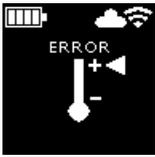
Temperatur Akku zu hoch/ Arbeitstemperatur Elektronik zu hoch
