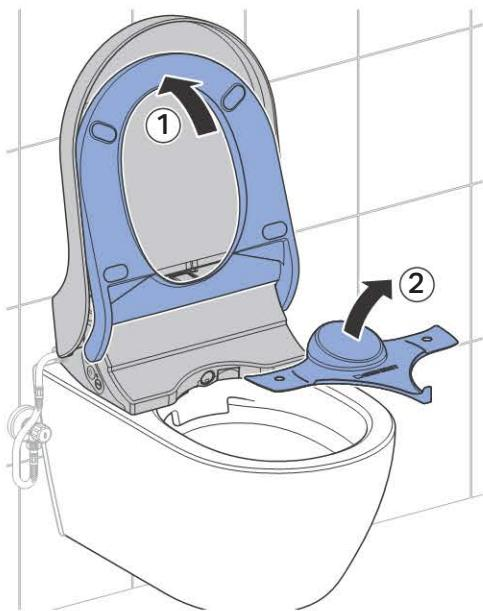
**2** Apparaat reinigen.
