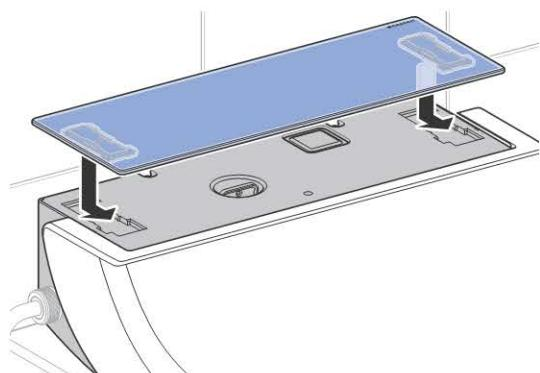
**5** Schutzfolie der Designabdeckung entfernen.
