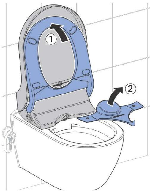
**2** Očistite napravo.
