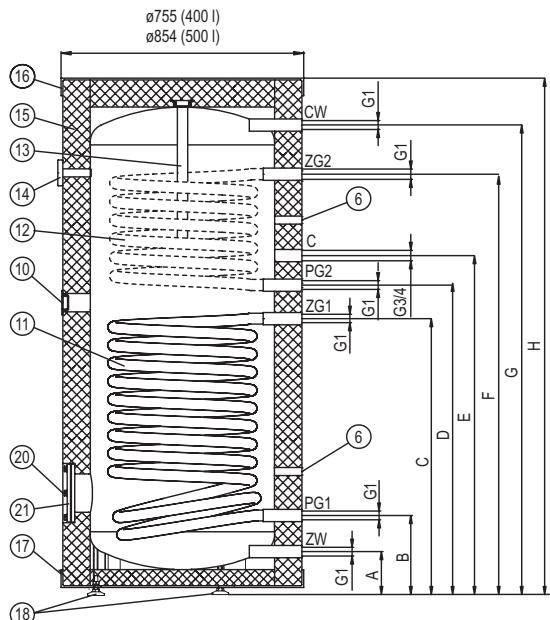
**Serpentin haut (raccords ZG2, PG2) et doigt de gant haut se trouvent que dans les modèles SB et SBZ.**
