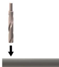
1. In die Wandung der Abwasserleitung ein Loch mit 10 mm Ø (für ACC00919) bzw. 18 mm Ø (für ACC00920) bohren
