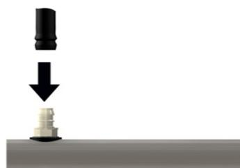
4. PVC-Schlauch aufstecken und gegebenenfalls mit Kabelbinder fixieren
