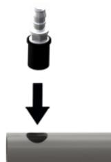
2. Ablaufstutzen mit dem schwarzen Gummitteil nach unten in das Bohrloch stecken
