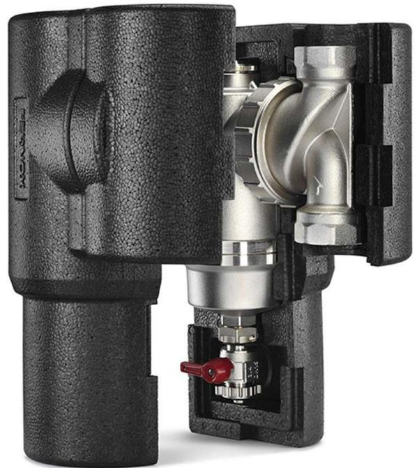
Expandiertes Polypropylen (EPP) wird als Wärmeabdeckung zur Isolierung von Fernox-Einlass-TF1-Systemfiltern zur Verwendung in Zentralheizungssystemen verwendet. EPP Thermal Covers kapseln Einlassfilter vollständig ein, um den Wärmeverlust des Systems auf ein Minimum zu beschränken.
