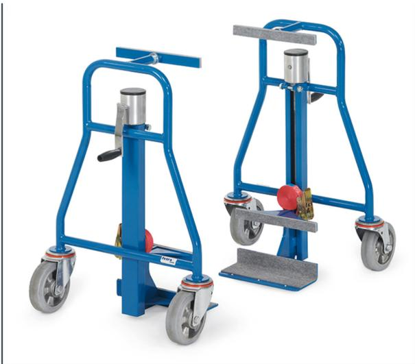
Mit Hand-Spindelwinde für den sicheren 1-Mann-Transport von Schränken. Stahlrohr-Konstruktion pulverbeschichtet blau RAL 5007, Winde mit Handkurbel, Spindel geschützt in einem C-Profil. Verstellbare Anlagestützen mit Schonbelag. Ladeplatte mit rutschhemmendem Belag. 2 Lenkrollen, Räder mit bodenschonender und spurloser Elastic-Vollgummi-Bereifung 160 x 50 mm, Naben mit Kugellager. 1 fest angebrachter Zurrurt 5 m lang. Lieferung paarweise.
