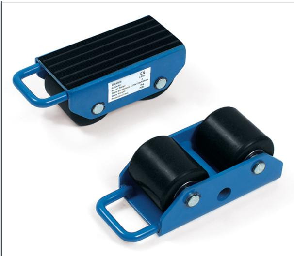
Für den leichten und sicheren Transport von schweren Gegenständen wie Behälter, Kisten, Maschinen usw. Stabile Stahl-Schweißkonstruktion, mit Handgriffen aus Rundstahl oder Stahlrohr, pulverbeschichtet blau RAL 5007. Tragplatten mit rutschhemmender Gummiauflage versehen. Große Nylonrollen kugelgelagert. Hohe Tragkraft bei geringem Eigengewicht. Rollengröße Ø x Breite 85x90 mm. Lieferumfang: 1 Stück
