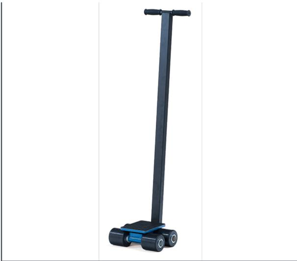
Für den leichten und sicheren Transport von Maschinen und anderen schweren Gegenständen. Stabile Stahl-Schweißkonstruktion, mit Handgriffen aus Rundstahl, pulverbeschichtet blau RAL 5007. Mit drehbarer Tragplatte und Zugdeichsel. Tragplatten mit rutschhemmender Gummiauflage versehen. Große Nylonrollen kugelgelagert. Rollengröße Ø x Breite 85x90 mm.
