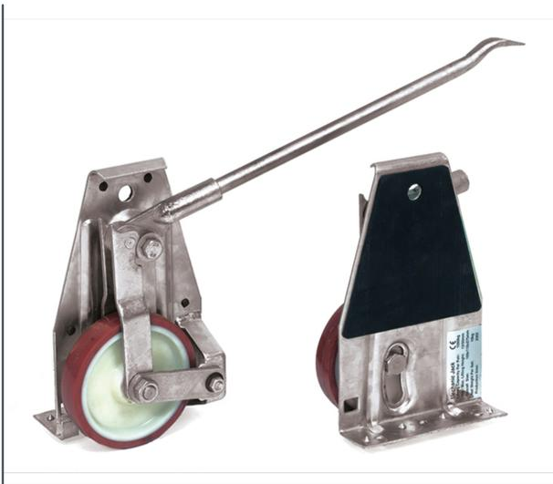
Für den Transport von schweren Schränken und dergleichen, Stahlblechgestell galvanisch verzinkt, Anlagefläche mit Gummibelag, Rad mit Polyurethan-Bereifung. Handhabung: Last mit Hebelstange anheben, Klaue der Hubrolle unterschieben, Anheben der Last durch Umlegen des Exzenterhebels mit der Hebelstange. Auf der Gegenseite ebenso mit der 2. Hubrolle verfahren und die Last ist verfahrbar. Klauenhöhe: abgesenkt = 12 mm, angehoben max. = 50 mm. Lieferumfang: 2 Hubrollen und 1 Hebelstange.
