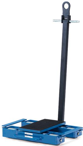
Für den leichten und sicheren Transport von Maschinen und anderen schweren Gegenständen. Stabile Stahl-Schweißkonstruktion, mit Handgriffen aus Rundstahl, pulverbeschichtet blau RAL 5007. Mit drehbarer Tragplatte und Zugdeichsel. Mit 1 Zugöse an der Deichsel. Große Stahlrollen, kugellagert. Tragplatten mit rutschhemmender Gummiauflage versehen. Große Nylonrollen kugellagert. Rollengröße  $\varnothing$  x Breite 85x90 mm.
