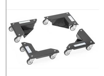
Zum Umsetzen von Möbeln oder anderen kastenförmigen Gegenständen. Niedrige Ladehöhe, sicherer Transport. Gehäuse aus Stahlblech geschweißt, pulverbeschichtet anthrazitgrau RAL 7016, Ladefläche mit Antirutsch-Auflage. 3 Lenkrollen mit TPE-Bereifung 50 x 18 mm, Naben mit Fadenschutz und Präzisions-Rillenkugellager. Lieferumfang: 1 Satz = 4 Stück in einem robusten Kunststoffkoffer.
