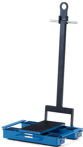
Für den leichten und sicheren Transport von Maschinen und anderen schweren Gegenständen. Stabile Stahl-Schweißkonstruktion, mit Handgriffen aus Rundstahl, pulverbeschichtet blau RAL 5007. Mit drehbarer Tragplatte und Zugdeichsel. Mit 1 Zugöse an der Deichsel. Tragplatten mit rutschhemmender Gummiauflage versehen. Große Nylonrollen kugelgelagert. Rollengröße Ø x Breite 85x90 mm.
