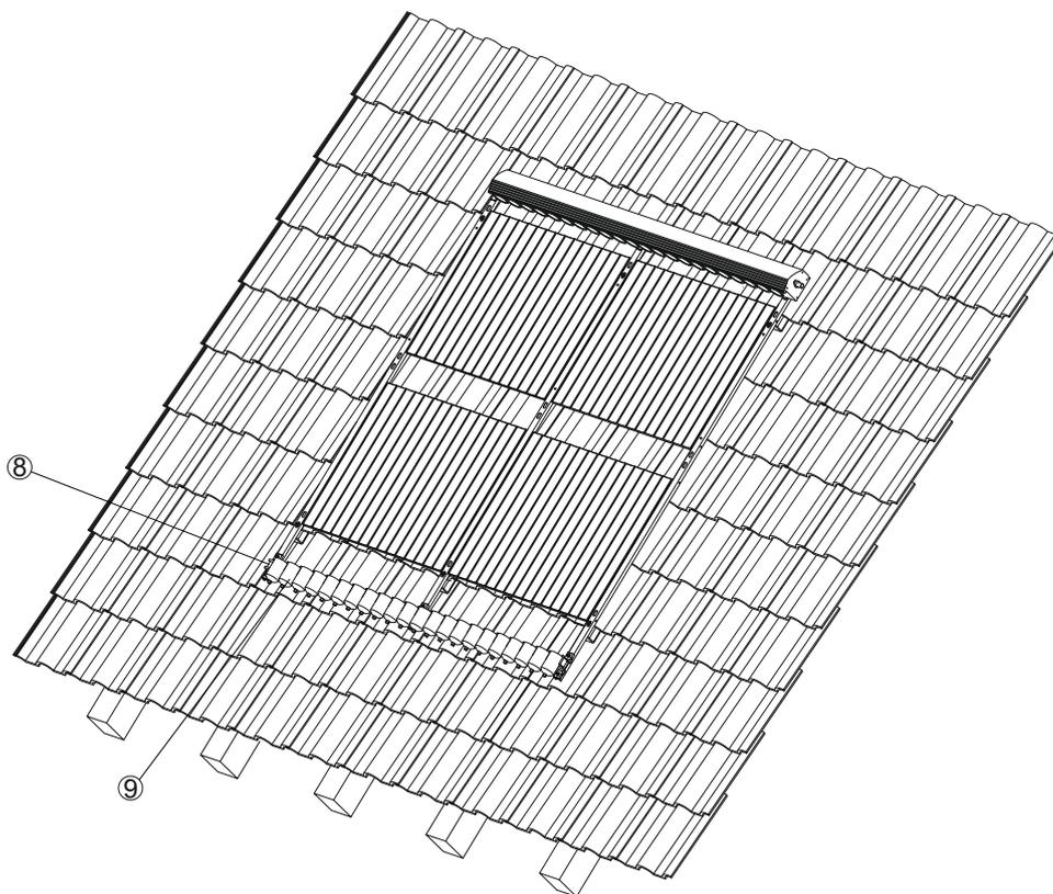
7. Insérez les tubes sous vide par le haut, en les glissant dans le collecteur. Insérez-les ensuite dans le support et fixez-les en fermant le support.
