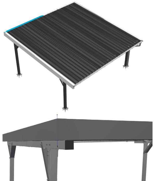
Befestigen Sie die Blenden an der Traufpfette mit den 5,5x19 mm Bohrschrauben mit Dichtscheibe von vorne und von unten. Oberhalb der Sparren wird der kurze Arm des L-Blech mittels Blechschere ausgespart.
