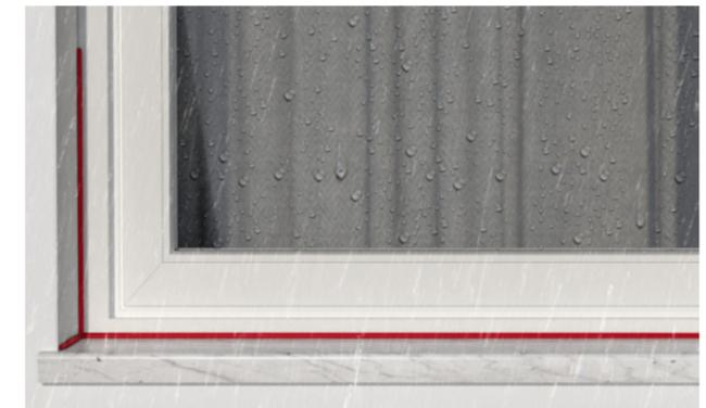
Dichtungsfugen im Außenbereich
