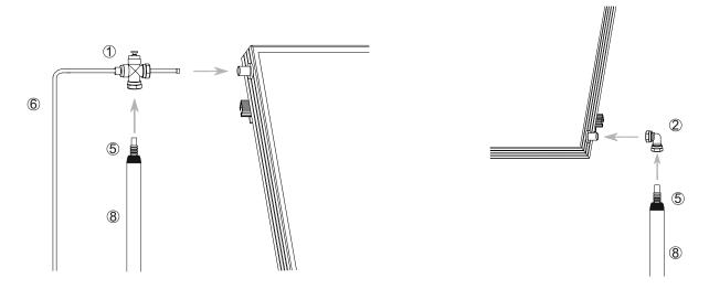
Achtung: Die Doppelkupplung mit der Entlüftung und Tauchhülse ① am Kollektorvolauf montieren, den Winkelanschluss ② an der Rückleitung montieren. Der Vorlauf wird als der Punkt der Entladung des heißen Mediums aus dem Kollektor verstanden
