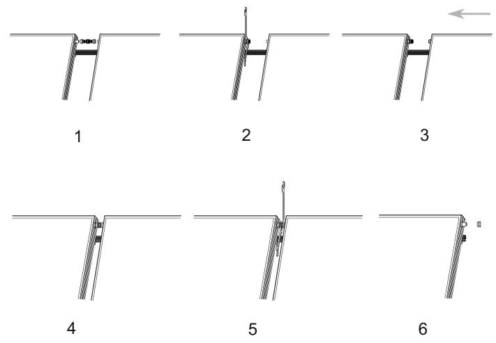
Die einzelnen Schritte müssen auch an der Unterseite des Geräts wiederholt werden Achtung: Die Anwendung von zu viel Kraft beim Festziehen der Komponenten des Anschlusssets kann zu Schäden am Gerät führen.
