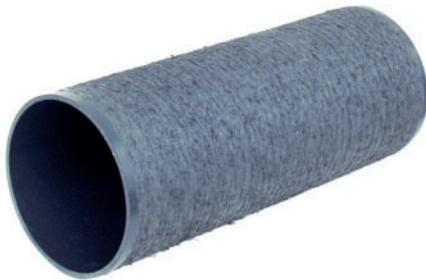
PVC-Mauerhülsen eignen sich zum Einbetonieren oder Einmauern. Sie werden in der Standardlänge von 400 mm geliefert und können bau-seits mit einer Säge der Wandstärke angepasst werden.
