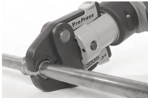
Abbildung 9 - Anbringen von Scherenbacken am Fitting
