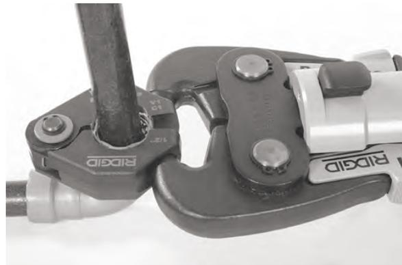
Abbildung 12 – Ansetzen des Stellantriebs am Pressring
