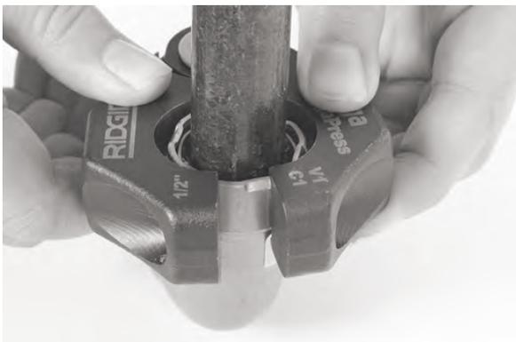
Abbildung 11 – Anbringen des Pressrings am Fitting
