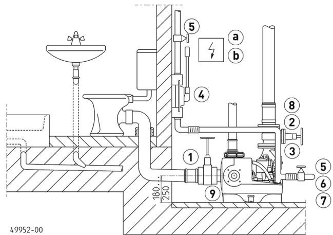
Die Anlagen haben einen Anschlussflansch DN 80/PN 10, jedoch mit Rohrstützen DN 100. Bei direktem Aufbau brauchen Rückschlagklappen und Absperrschieber deshalb nur in DN 80 gewählt werden. Die weiterführende Druckleitung wird mit DN 100 durch die elastische Verbindung angeschlossen. Fäkalienhebeanlagen sind nach den Bau- und Prüfgrundsätzen der EN 12050 zur Förderung von Fäkalien und häuslichem Abwasser (EN 12056, DIN 1986-3) in der Gebäudeentwässerung
