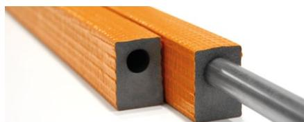
Exzentrisch extrudierte Rohrisolierung aus geschlossenzelligem Polyethylen-Schaum mit NMC Naturefoam® mit einem Anteil von mindestens 50% nachwachsenden Rohstoffen, mit co-extrudierter PE-Folie.
