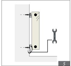
Bloquer le radiateur et recouvrir les supports avec le cache plastique spécial (Fig. 6/7) :
