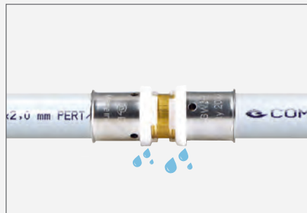
ZWISCHEN 1 UND 4,5 BAR GEPRÜFT NIGHT VERPRESSTER FITTING - UNDICHT / RACCORDS NON SERTI, TEST EN PRESSION À 1-4,5BAR - IL FUIT
