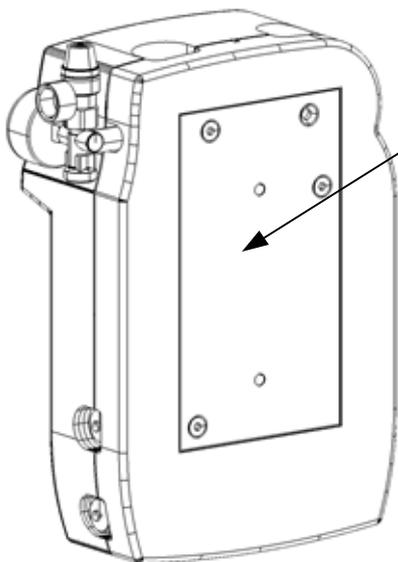
Plaque sur le derrière de la coque isolante pour fixer le module au mur ou au ballon
