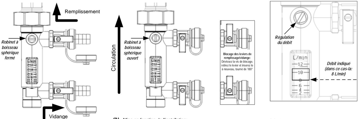
(1) - Remplissage de l'installation: Retirez les bouchons des deux vannes latérales et branchez les porte-tuyaux. Fermez le robinet à boisseau sphérique et ouvrez les robinets de remplissage et de vidange à côté.
