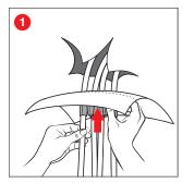
Kabel schräg anschneiden und die Membranen der Manschette durchstoßen.
