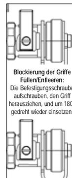
**Blockierung der Griffe Füllen/Entleeren:** Die Befestigungsschraube aufschrauben, den Griff herausziehen, und um 180° gedreht wieder einsetzen.
