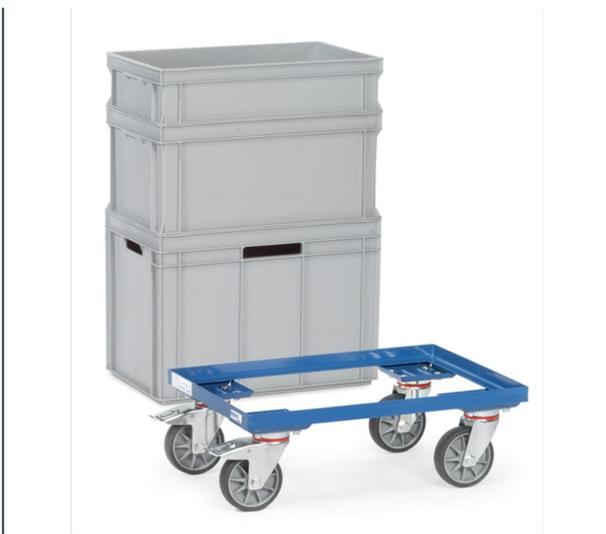
Offene Winkelstahlkonstruktion, pulverbeschichtet blau RAL 5007. 4 Lenkrollen mit TPE-Bereifung, Naben mit Rillenkugellager. 2 Stück mit Feststeller, gemäß der Europäischen Norm EN 1757-3 (Sicherheit von Plattformwagen). Passend für Eurokästen 600 x 400 mm.
