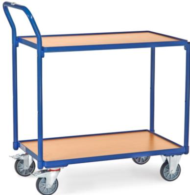
Leichter Tischwagen im Baukasten-System. Stahlrohr und Profilstahl geschweißt, pulverbeschichtet. Schraubkonstruktion. 2 Böden aus Holzwerkstoffplatte, Oberfläche Buchendekor, im Stahlrahmen liegend, Rand 12 mm hoch. Schiebegriff hochstehend. 2 Lenk- und 2 Bockrollen, TPE-Bereifung, Naben mit Rillenkugellager. Feststeller an den Lenkrollen, gemäß der Europäischen Norm EN 1757-3 (Sicherheit von Plattformwagen). Tragkraft obere Ladefläche 80 kg.
